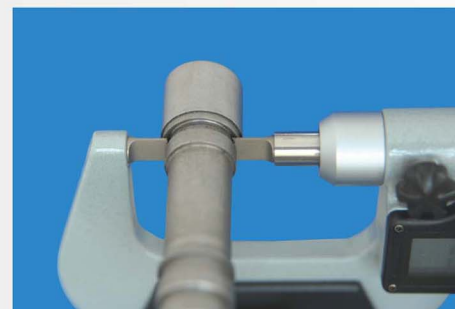
测量零件槽尺寸
